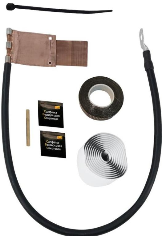
**КЗ-ЭБК-МЛ** выпускаются на пять диапазонов диаметров. Сечение провода заземления – 6, 10, 16 мм<sup>2</sup>, длина – от 0,6 до 2.0 м. Для подключения к заземлению установлен кабельный наконечник.
